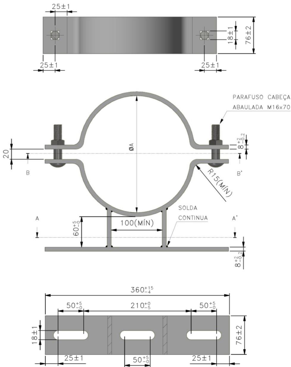
Figura 1 – Suporte para Instalação de Transformador – Tipo 1
